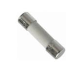
**5HT 10** Bel FUSE CERAMIC 10A 250VAC 5X20MM
