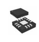
Peregrine Semiconductor RF ATTENUATOR 8DB 50OHM 12WFQFN
