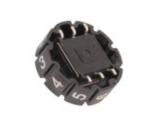
DH101ARSMT002 APEM Inc. SWITCH ROTARY DIP BCD 100MA 42V
