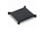
MC68302EH16C NXP USA Inc. IC MPU M683XX 16MHZ 132QFP
