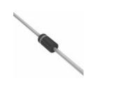
1N4007RL **ON Semiconductor** DIODE GEN PURP 1KV 1A DO41
